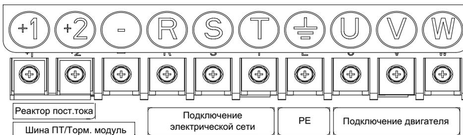
Рисунок 4.9. Силовые клеммы NVF2G-110/TS4-160/PS4
