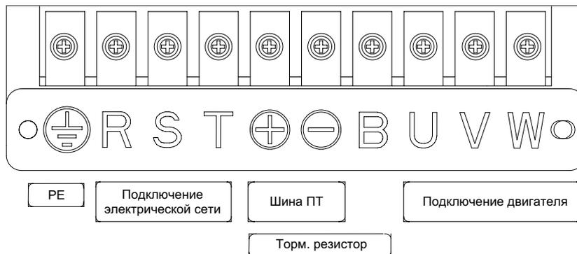
Рисунок 4.6. Силовые клеммы NVF2G-1.5/PS4–30/PS4
