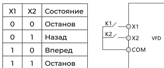
Рисунок 8.1.1. Режим двухпроводного управления 1
