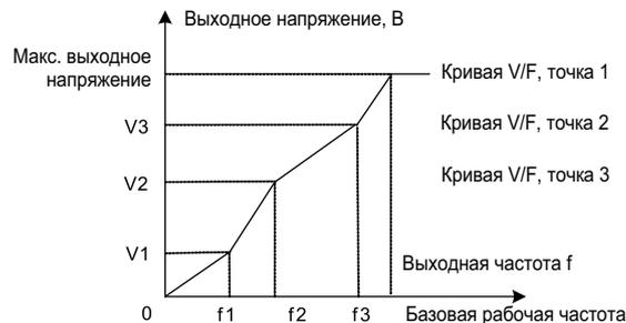
Рисунок 8.5.2. Многоточечная кривая V/F
