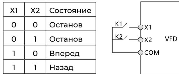
Рисунок 8.1.2. Режим двухпроводного управления 2
